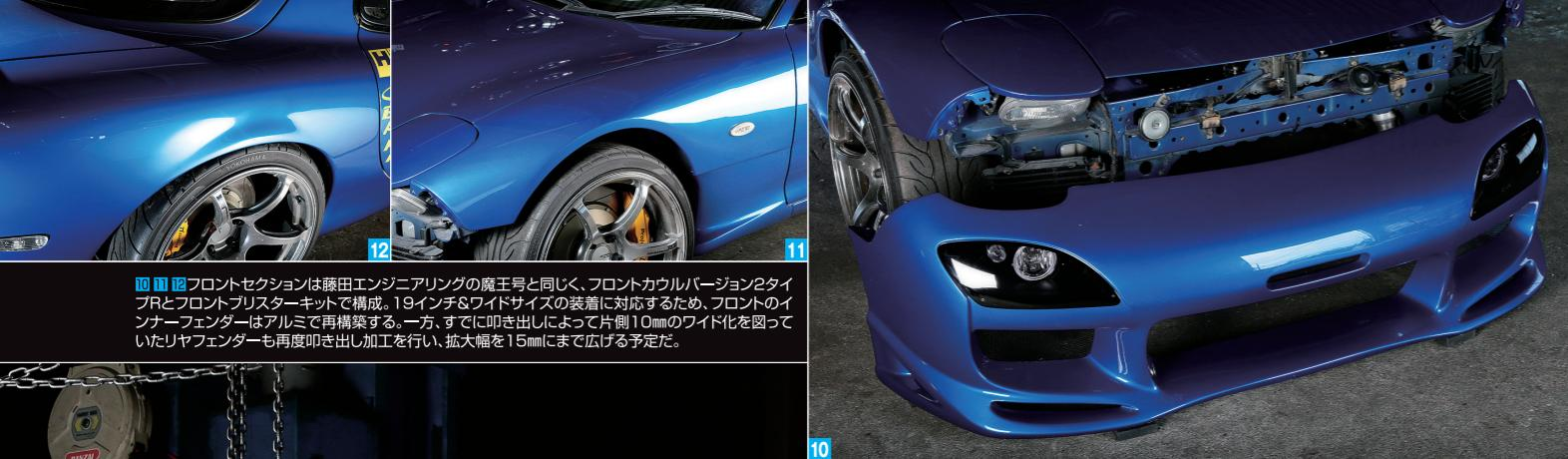
⑩⑪⑫フロントセクションは藤田エンジニアリングの魔王号と同じく、フロントカウルバージョン2タイプRとフロントブリスタークリップで構成。19インチ&ワイドサイズの装着に対応するため、フロントのインナーフェンダーはアルミで再構築する。一方、すでに叩き出しによって片側10mmのワイド化を図っていたリヤフェンダーも再度叩き出し加工を行い、拡大幅を15mmまで広げる予定だ。
