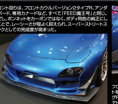
フロントフェンダーは藤田エンジニアリングのブリスター・キットを組み込み、ワイド化。10J×19+22の「アドバンレーシングRS-RFプロゲッジ」を装着。タイヤは255/30R19のアドバンオバ(ADO8R)だ。
