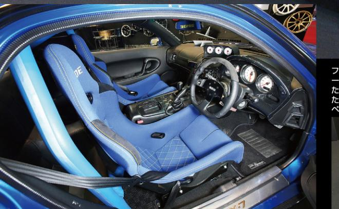
車内はブルーのブリッド製フルバケ、マツダスピードのカーボンパネルなどでコーディネート。FD3Sはリヤセクションの剛性不足が指摘されるため、ナイトスポーツのロールバーを組み込み、剛性アップを図っている。
