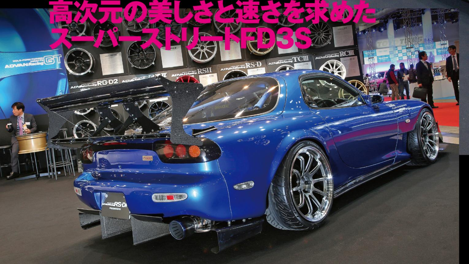
「ベースストリートRX-7に仕立てて欲しい」とリクエストしていた。エンジンは基本的にフジタエンジニアリング代表の藤田さんによると、「これからもトラブルフリーでチューンドRX-7に乗り続けるには、熱害を軽減したい」と、タービンは純正シーケンシャルツインからTO4Sシングルに変更。エンジンはサイドポート加工を施し、450psを発生する。これと並行して、エクステリアの大幡なエディファイも敢行。こちらは萩原さんがデザイナーとしてのセンスをフルに發揮し、パーソナリストがシンプルだと、ローフォルムが引き立つから」と言うことだ。最後まで悩んだりヤセクションは、あえてボディ同色の純正を選択。「ボネットがシンプルだ」と、ローフォルムが引き立つから」と言うことだ。
