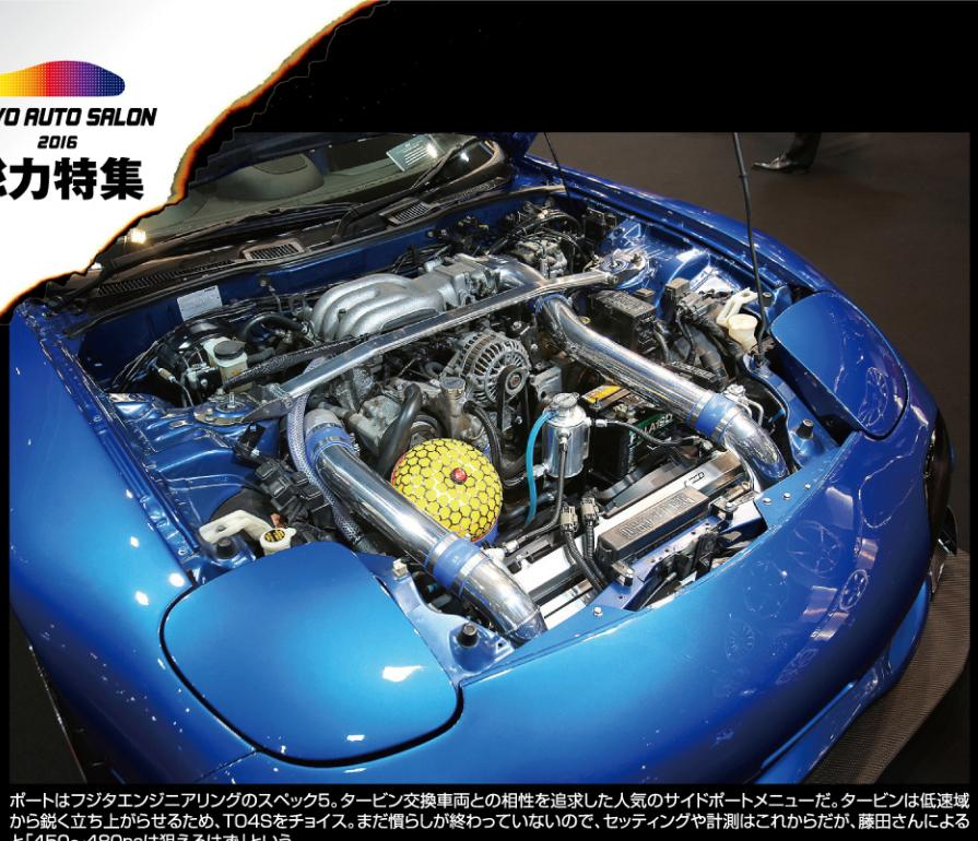
ポートはフジタエンジニアリングのスペック5。タービン交換車両との相性を追求した人気のサイドポートメニューだ。タービンは低速域から鋭く立ち上がりせるため、TO4Sをチョイス。まだ慣らしが終わっていないので、セッティングや計測はこれからだが、藤田さんによる「450~480psは狙えるはず」という。
