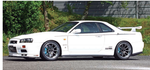
力強さを強調するGTに比べて、RS-DFはスポークも細く繊細な印象。ただし、10本スポークは応力分散に優れ、GT同等の剛性を確保しながら、軽量化で凌駕している
